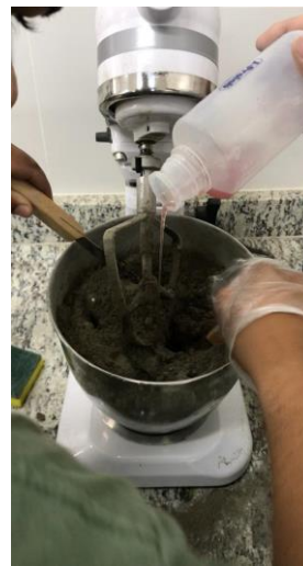
(b) Superplastificante sendo adicionado
