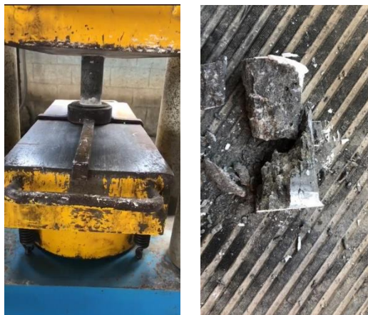
(a) Corpo de prova na prensa (b) Corpo de prova rompido
