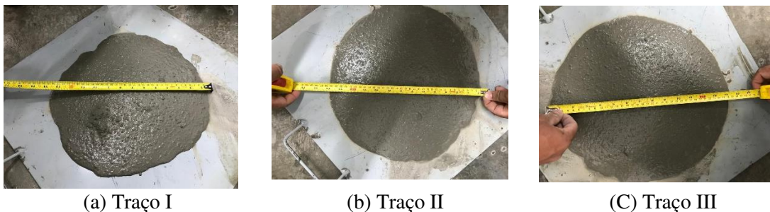
Figura 14 - Aspecto e ensaio e determinação do diâmetro no ensaio espalhamento do CUAD.
