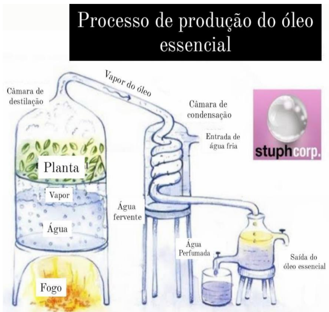
Figura 1: Processo de extração dos óleos essenciais. Fonte: https://www.stuphcorp.com/pt/essencial-oilnanoemulsions.htm .
