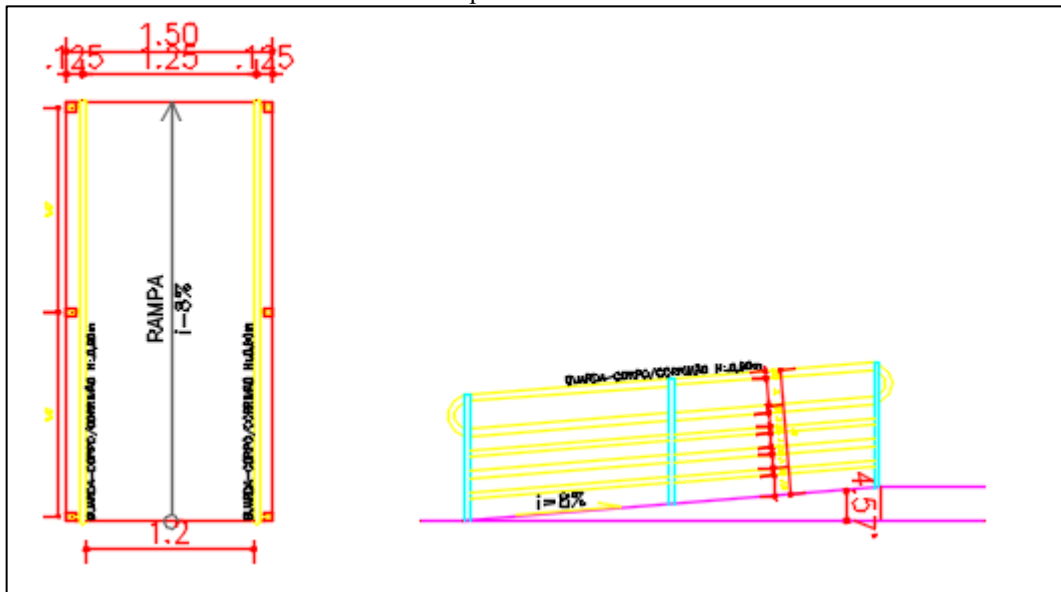
Detalhe 05 - Rampa de acessibilidade - folha 06.
