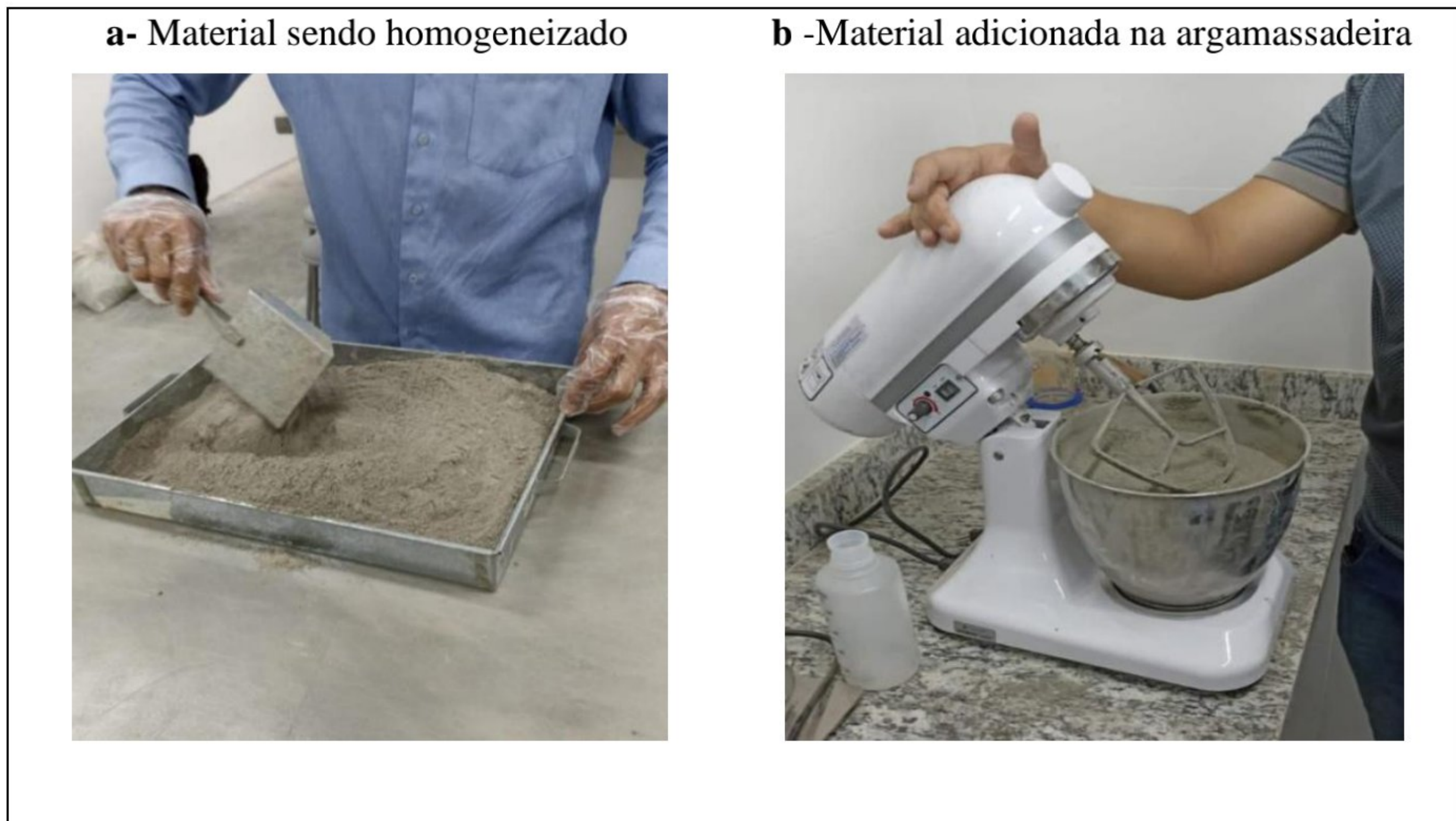
Figura 7 – Etapas do processo de mistura dos matérias
