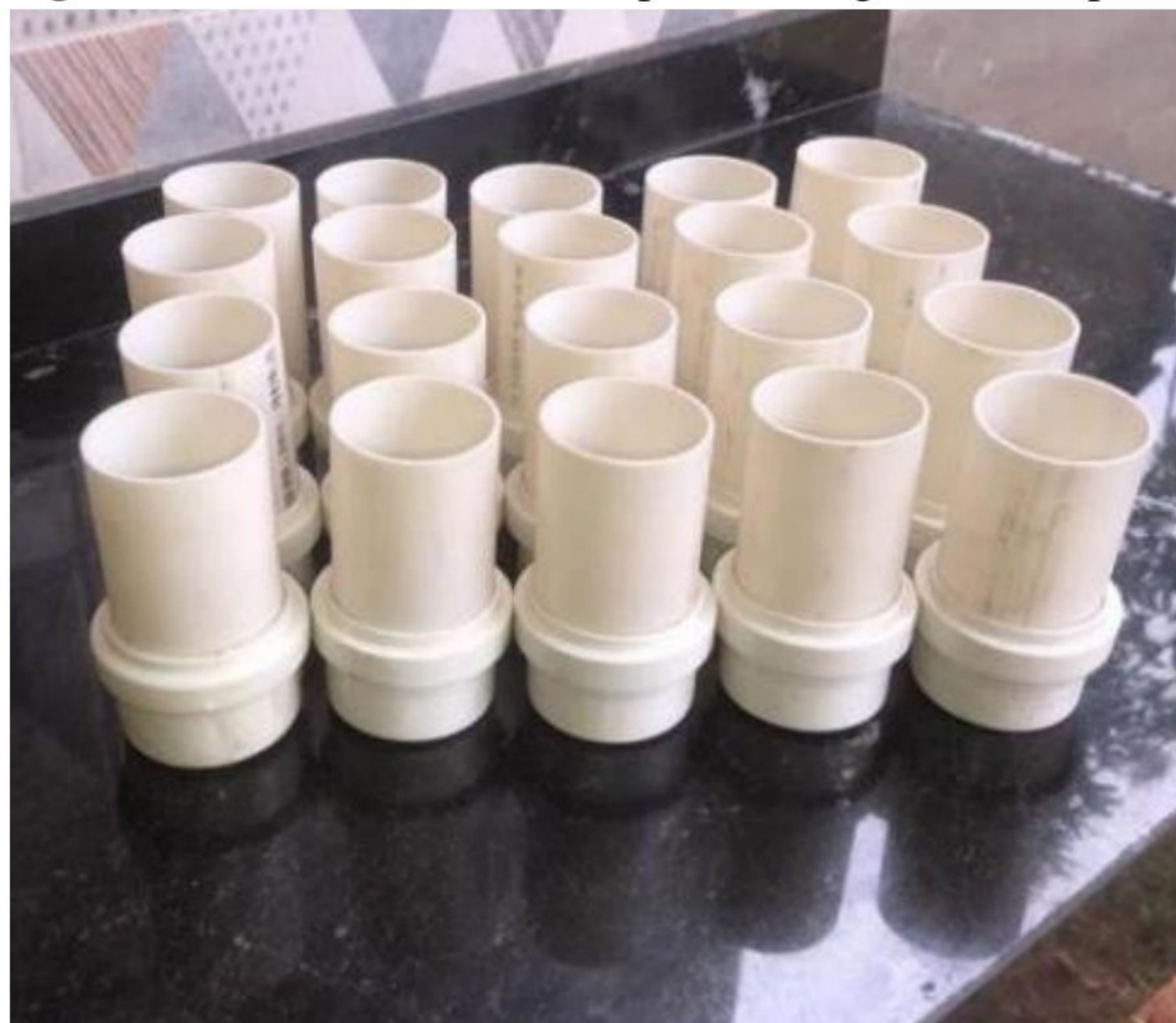
Figura 9 – Formas de cano PVC para moldagem dos corpos de prova
