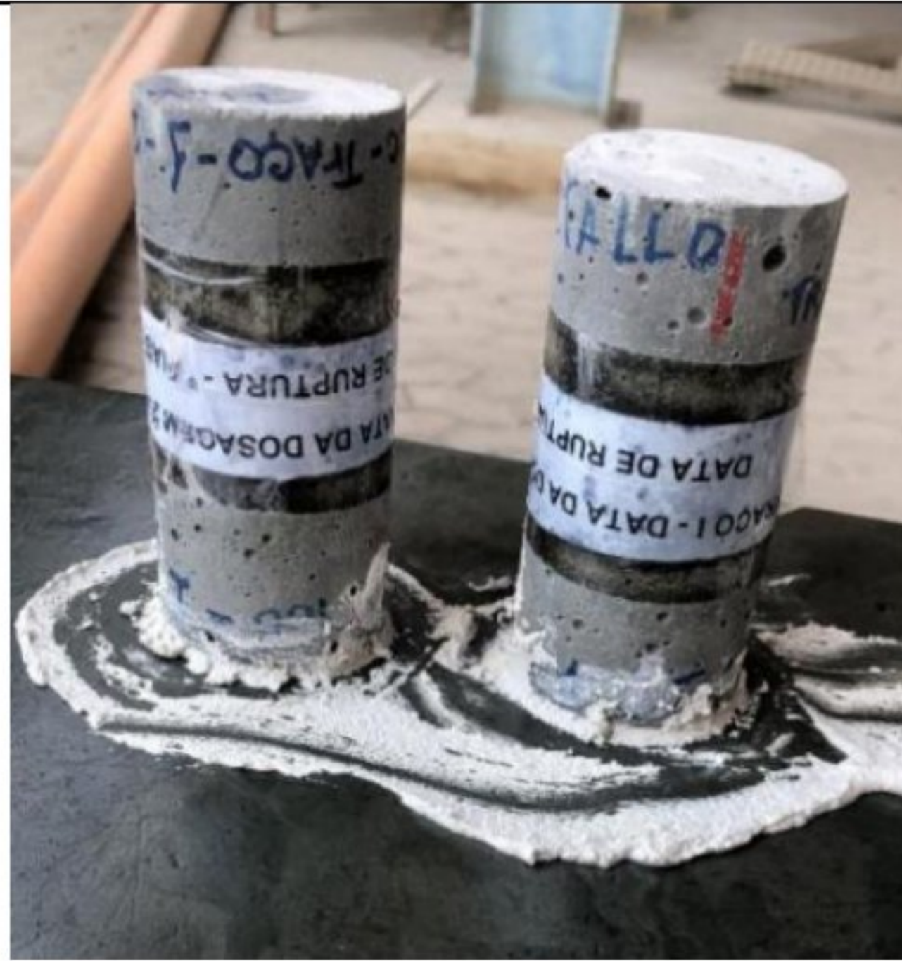
(a) – Capeamento do CP com gesso
