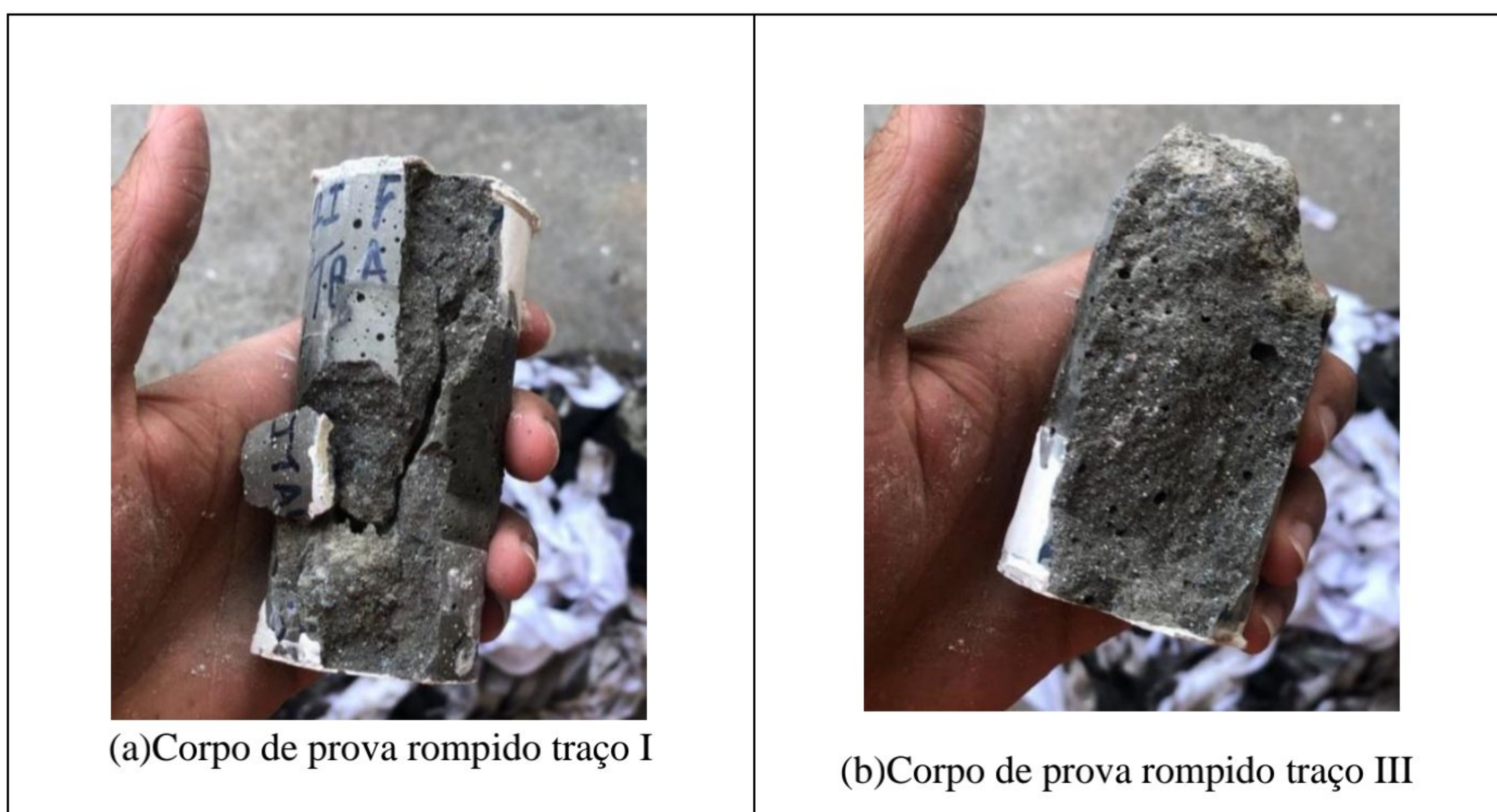
Figura 13 - Corpos de prova após teste de resistência na prensa
